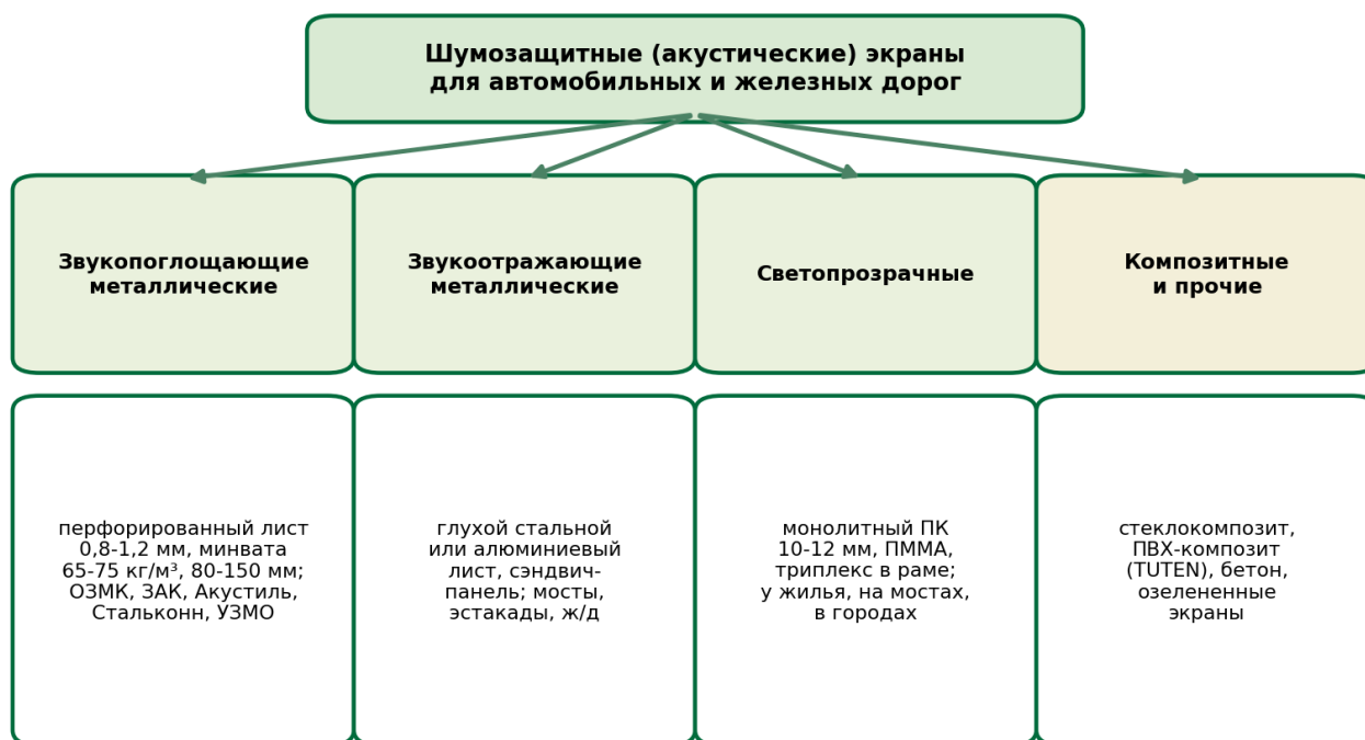
Рисунок 1. Классификация шумозащитных экранов по типу панелей
