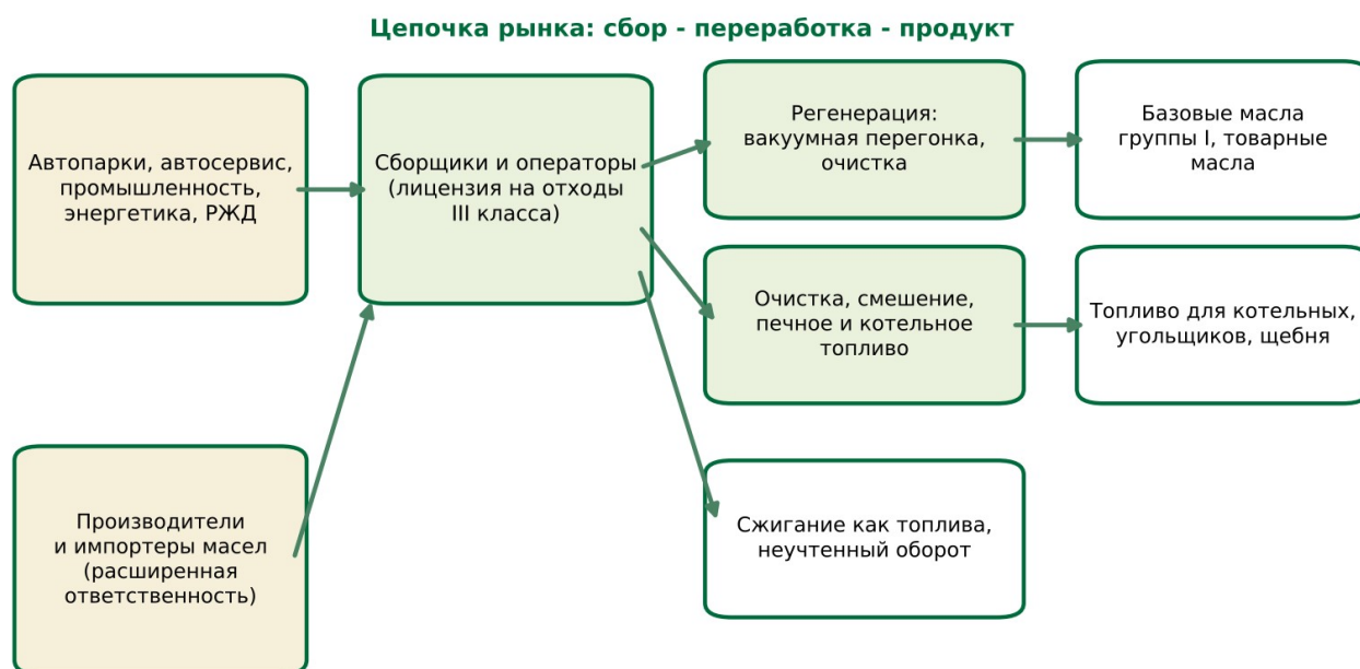
Рисунок 1. Цепочка рынка сбора и регенерации отработанных масел
