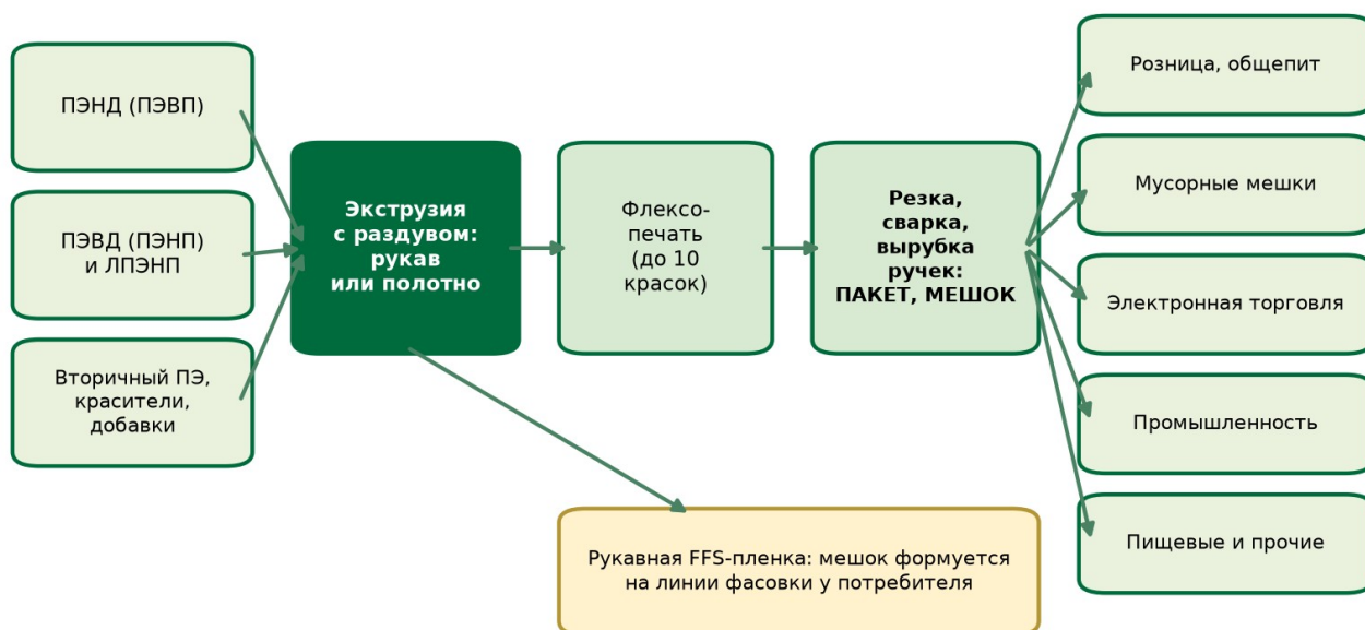
Рисунок 1. Цепочка производства полиэтиленовых пакетов и мешков
