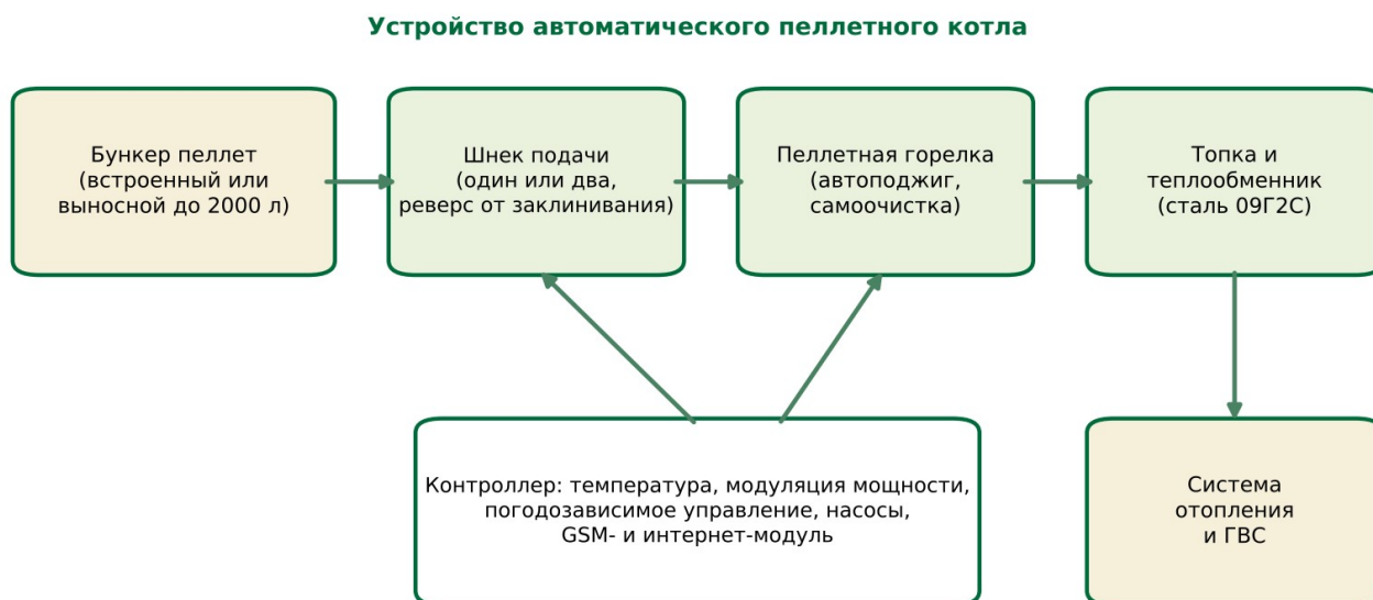
Диаграмма 1.1. Устройство автоматического пеллетного котла
