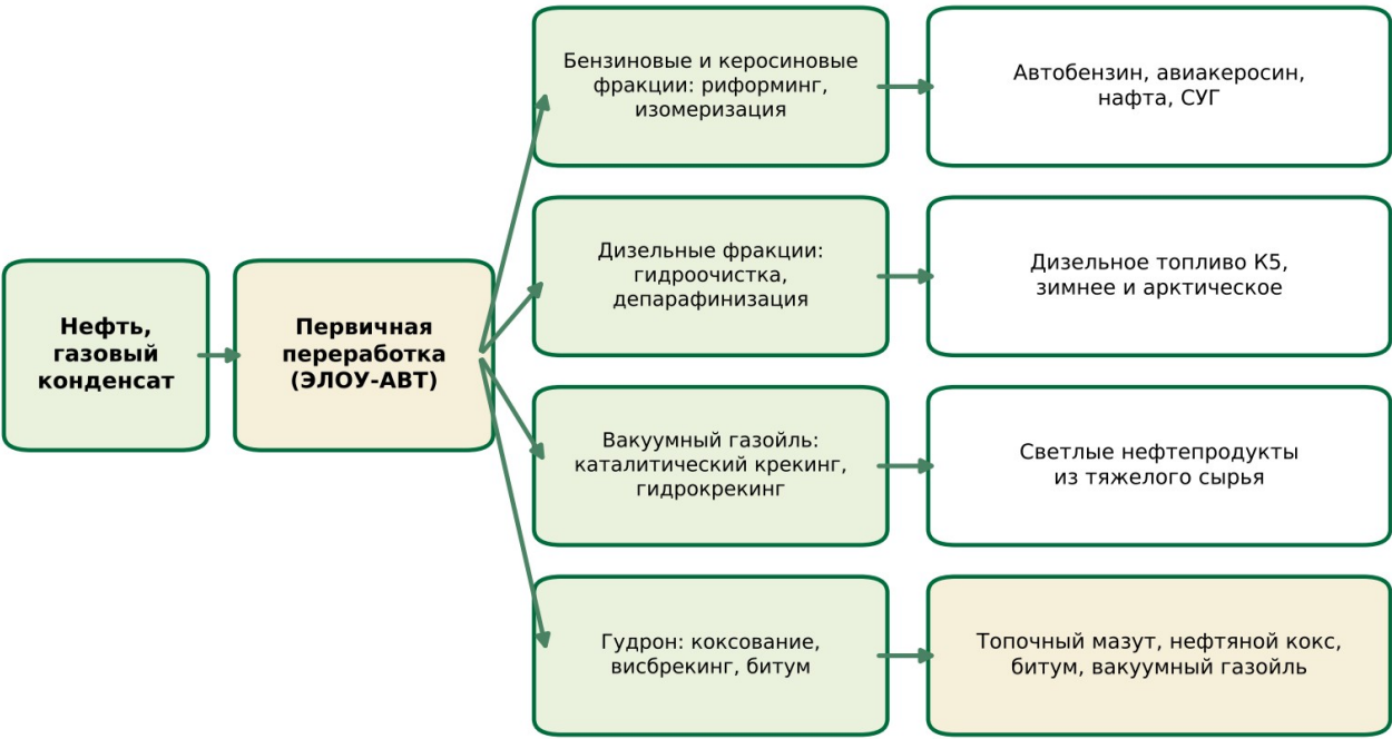
Рисунок 1. Технологическая цепочка нефтеперерабатывающего завода
