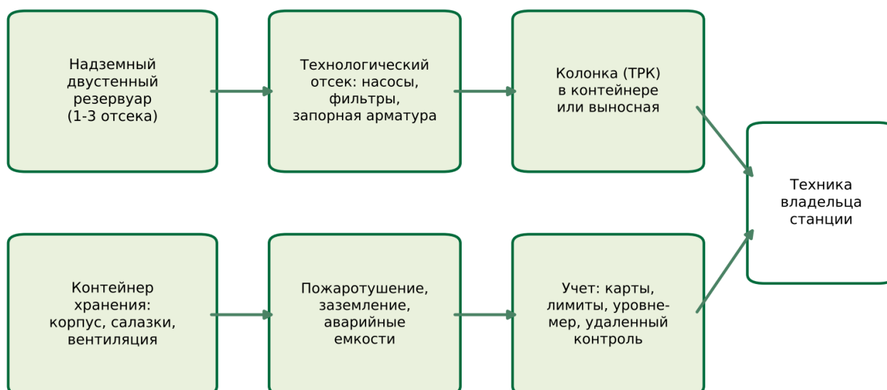
Рисунок 1. Устройство контейнерной АЗС
