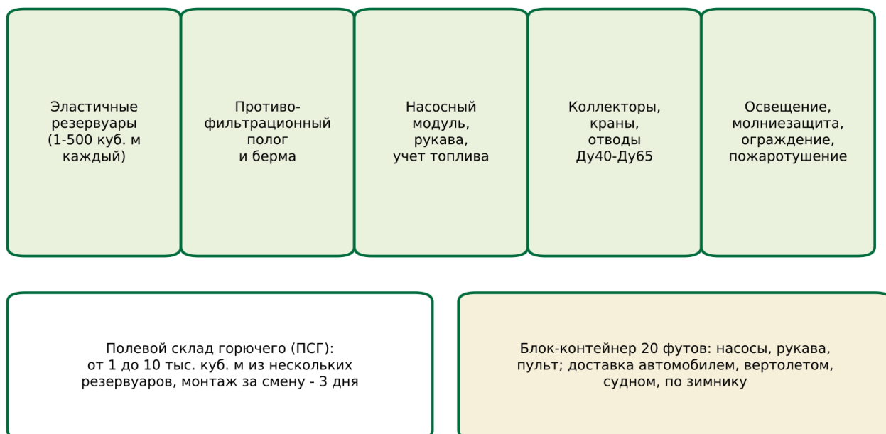
Рисунок 1. Состав полевого склада горючего на эластичных резервуарах
