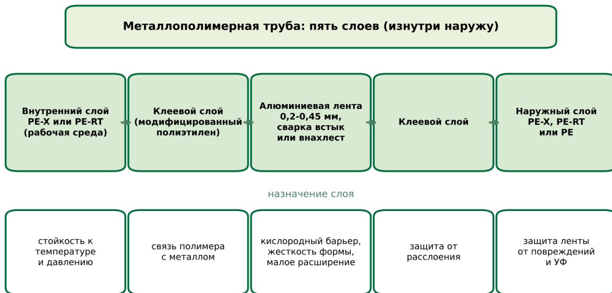
Рисунок 1. Устройство металлополимерной трубы и назначение слоев
