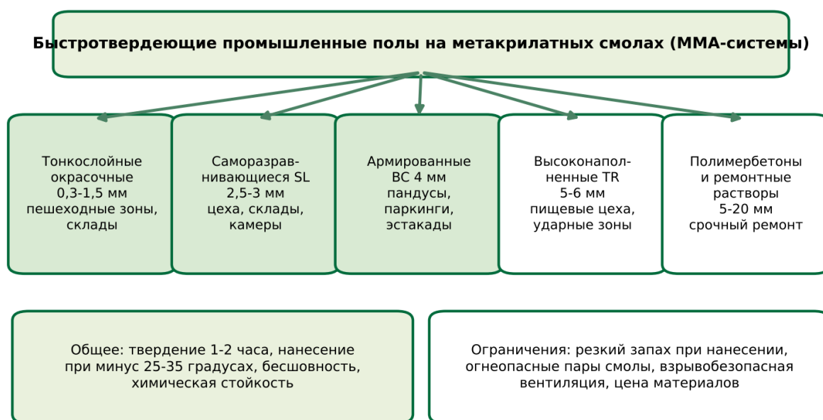
Рисунок 1. Виды метакрилатных систем промышленных полов и рамки исследования
