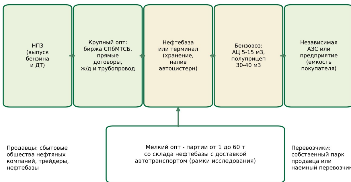
Рисунок 1. Цепочка поставки топлива от НПЗ до покупателя мелкого опта
