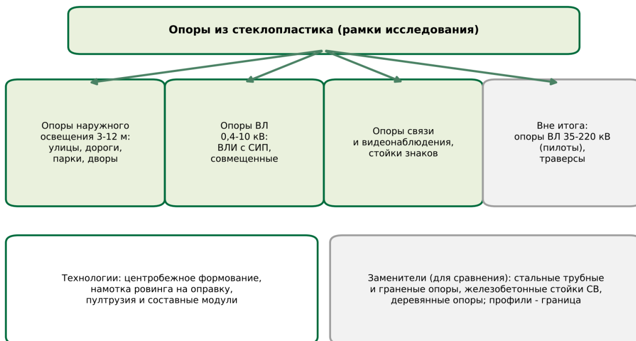
Рисунок 1. Виды стеклопластиковых опор и рамки исследования
