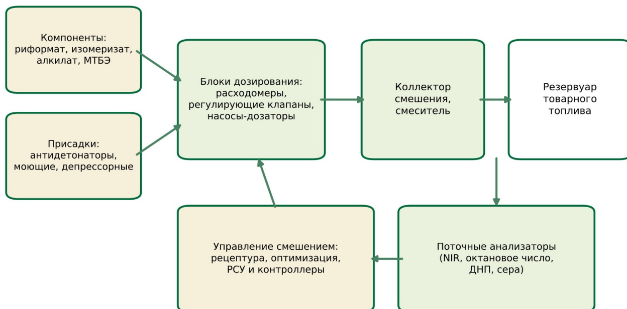
Рисунок 1. Устройство станции поточного компаундирования бензина на НПЗ
