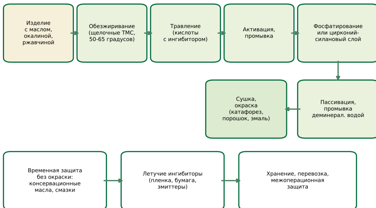
Диаграмма 1.1. Цепочка операций: подготовка поверхности перед окраской и временная защита металла
