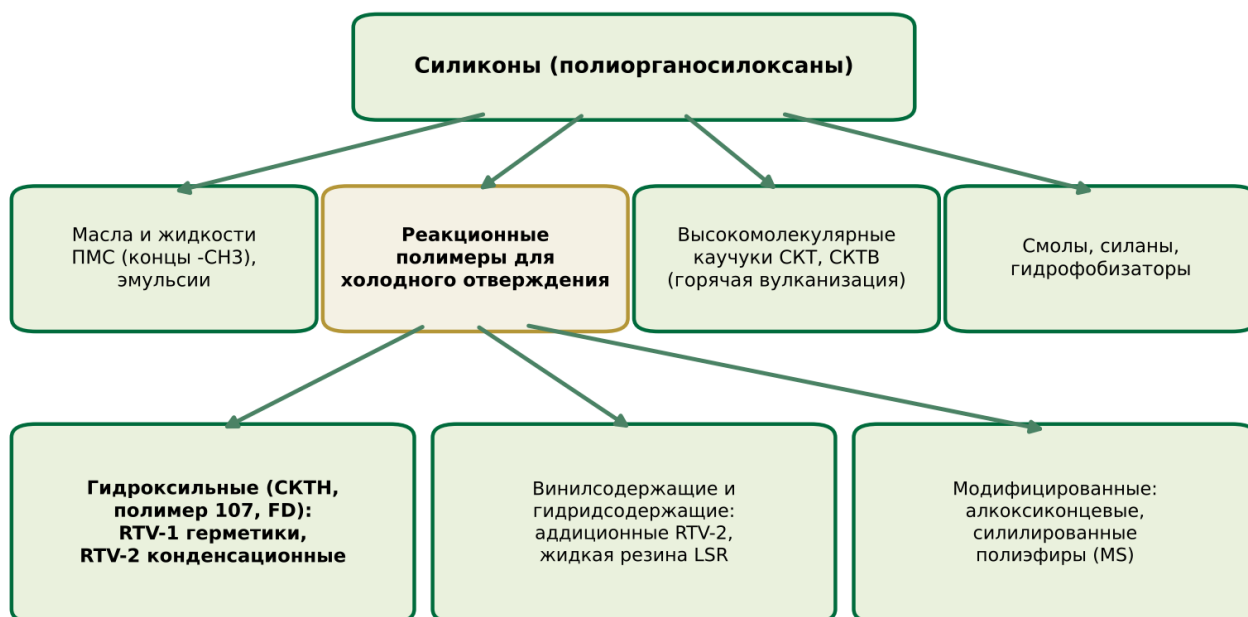
Диаграмма 1.1. Классификация силиконов и место гидроксильных полимеров
