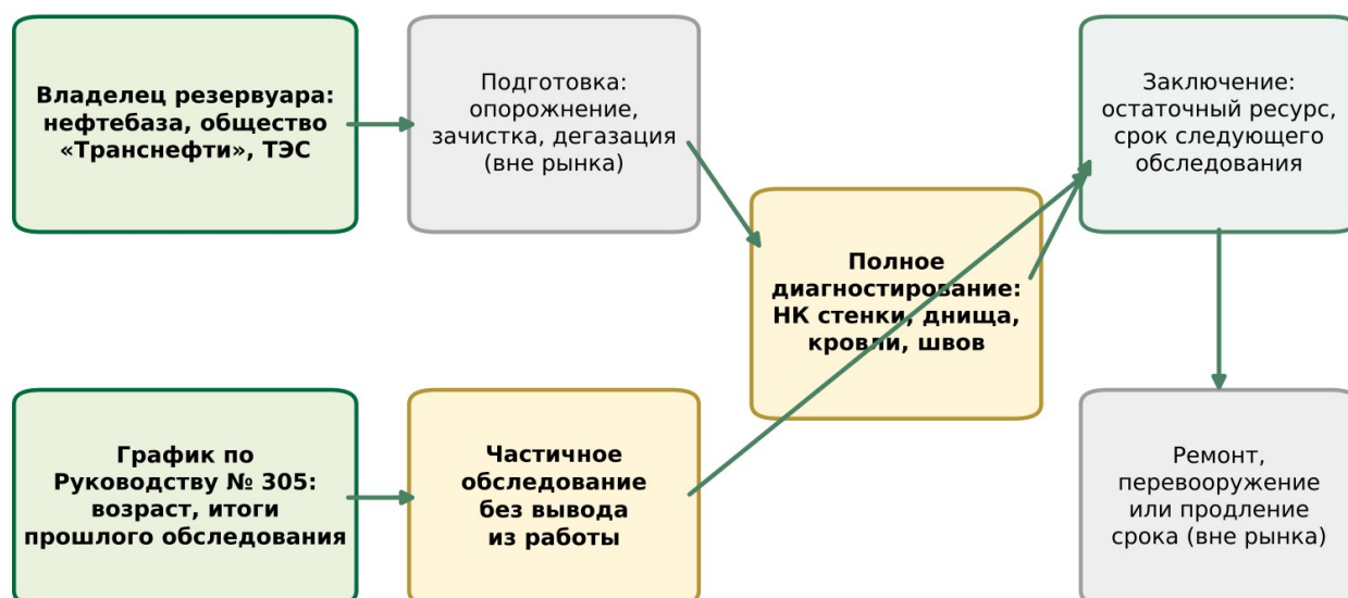
Рисунок 1. Цепочка работ при техническом диагностировании резервуара
