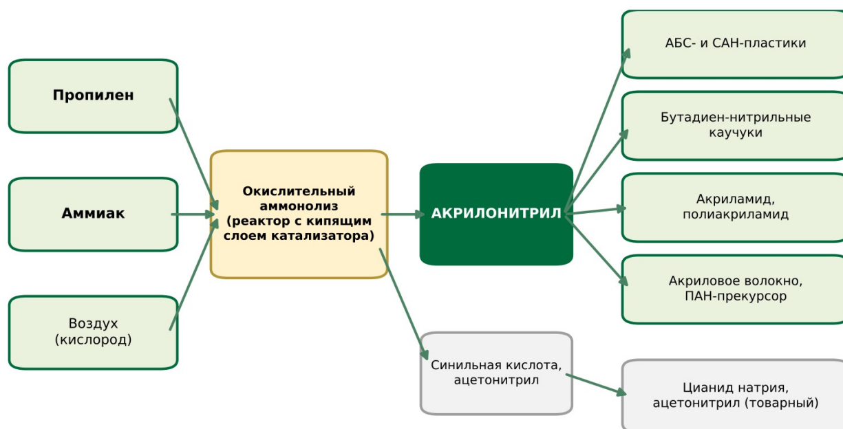
Рисунок 1. Цепочка получения и переработки акрилонитрила
